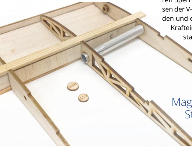
▶ Die Alu-Hülsen für die GFK-Steckungsstäbe sitzen zwischen zwei Sperrholz-Rippen. Um die Stäbe an Ort und Stelle zu halten, werden die Hülsen mit einem Sperrholz-Deckel verschlossen.
