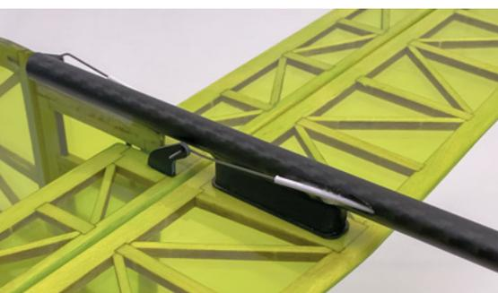
Die Anlenkung des Höhenruders erfolgt auf der Unterseite, der Bowdenzug wird seitlich aus dem Rumpfrohr herausgeführt.
