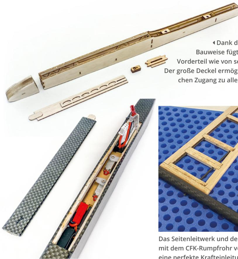
◀ Dank der durchdachten Bauweise fügt sich das Rumpfvorderteil wie von selbst zusammen. Der große Deckel ermöglicht einen einfachen Zugang zu allen Komponenten.
