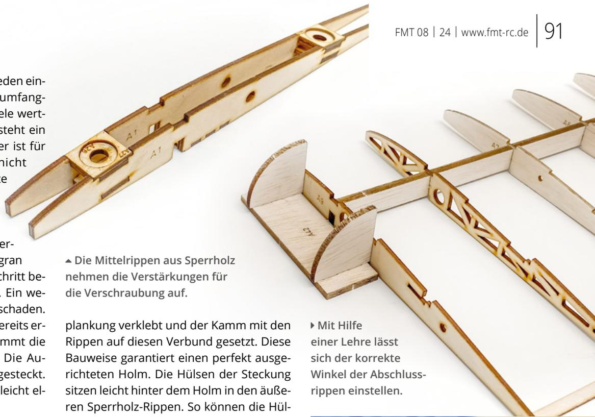
▶ Die Mittelrippen aus Sperrholz nehmen die Verstärkungen für die Verschraubung auf.
