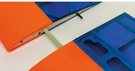
Die Außenflügel werden über einen GFK-Stab an das Mittelteil gesteckt. Gesichert werden sie mit einem Streifen Klebeband.
