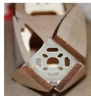
Die vier Balsastücke bündig mit dem Motorspant schleifen
