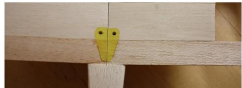
**ACHTUNG:** Die Rumpf-Seitenteile unterscheiden sich an der Aussparung für den Motorspannt. Damit wird der Sturz und Zug für den Motor vorgeben. Die Beschriftungen der Seitenteile müssen inwendig liegen!
