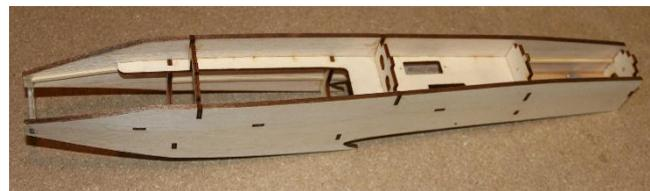
Im Bereich des Deckels die 5x5 mm Balsaleisten bündig mit den Seiten einleimen, vorher im Bereich der Flügelaufnahme **an schrägen** und an die Seiten anpassen.
