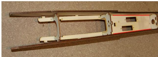
Das fertige Flügelaufnahmebrett mit den Einschlagmuttern nach unten zusammen mit Spant 8 am Rumpffende in den Spant 7 schieben und mit den Rumpfseiten von unten verleimen. Sind die Ecken am Flügelmontagebrett gut geschliffen worden, ist der letzte Spant 8 mit den Rumpfseiten bündig. Ansonsten muss noch einmal nach gearbeitet werden.
