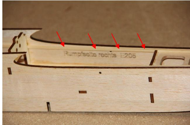
Spant 4 und 6 können nun von der Unterseite in die Seiten bis in das Servobrett Nr.10 eingeschoben werden. Passt alles einwandfrei, kann es verleimt werden.
