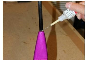
Passt alles, wird mit einem Tropfen Leim am Spant 7 gesichert.
