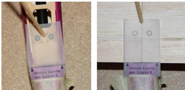
Die Flügel müssen vor dem Bohren genau ausgerichtet sein.
