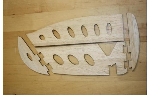
Durch die Verzahnung entsteht auch eine äusserst stabile Zelle, die dem Rumpf eine ausgezeichnete Stabilität verleiht!
