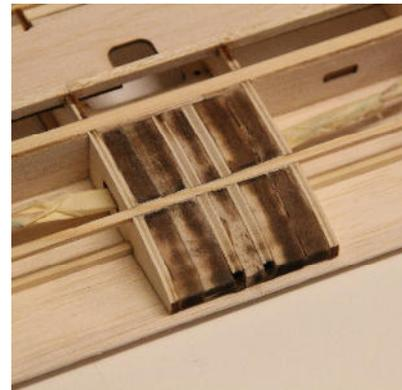
Auch vor der oberen Beplankung müssen die Zuleitung zu den Servos eingebaut werden. Für einen sicheren Halt liegt der kleine Rahmen bei, der auf die Stecker-Hülse passt und so sicher verleimt werden kann.
