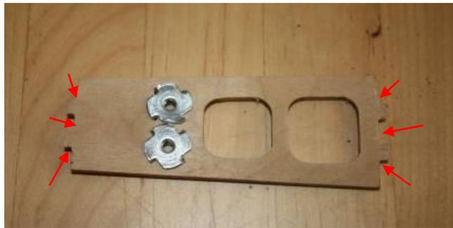
Die Spanten 3 und 5 auf einer geraden Unterlage in das Servobrett Nr.10 stecken, 90° ausrichten und mit Sekundenleim an punkten. Nicht auf die Unterlage leimen!
