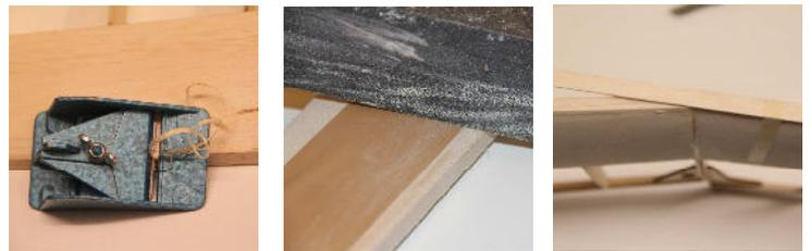
So werden alle drei Schichten nacheinander geleimt und geschliffen. Im Flügel Knick abwechselnd überlagernd bringt das Stabilität und der Sekundenleimt etwas Härte in Holz.
