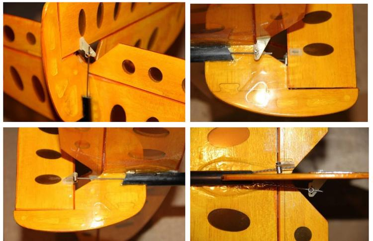
Die bereits schon abgewinkelten 1,2mmØ Gestänge in den Servohebel und von unten einfahren.
